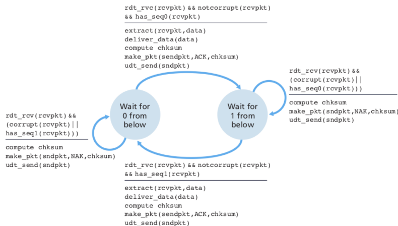
Figura 2: Un ricevente con dei problemi per il protocollo rdt.2.1
